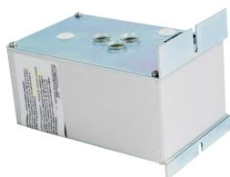
L'interface de commutateur SSR nVent RAYCHEM série 920 fournit une surveillance du courant monophasée universelle, une détection des courts-circuits à la masse triphasés ou monophasés et une surveillance de tension. Un dispositif est requis pour chaque point de contrôle. Comprend une alimentation universelle, permettant le fonctionnement direct de 100 à 277 V c.a.
