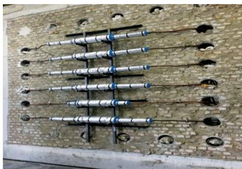
Figure 4. Paroi test de câble UL 2196
