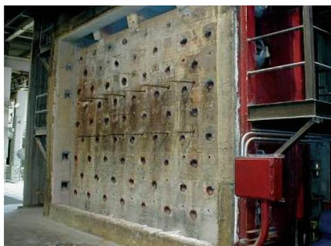
Figure 5. Four de test UL 2196
