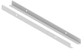
Les barres de levage offrent la meilleure distribution de charge tout en soulevant les armoires accouplées, chacune supportant jusqu'à 3 000 lb (1 361 kg) par baie d'équipement et de câblage. Les barres sont montées par dessus les blocs de coin du châssis de l'armoire et leur installation ne nécessite pas la dépose du couvercle supérieur. Le kit comprend deux barres, deux boulons et deux rondelles.
