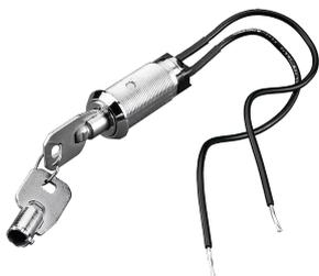
Permet au personnel autorisé d'entrer dans une armoire sous tension. Le déverrouillage est un commutateur à contact momentané à clé avec des contacts normalement fermés. La rotation de la clé désengage le circuit du verrouillage électrique.
