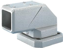
Le système de positionnement Compact série 4 permet de fixer un système de suspension à une surface horizontale. Le bras peut pivoter ou tourner à 306 degrés. Comprend une plaque d'accès pour faciliter le filage. Le palier pivotant est sans entretien.
