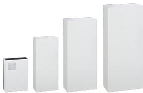
L'échangeur thermique d'intérieur air-eau élimine la chaleur d'une armoire en faisant circuler l'air chaud à travers le noyau de l'échangeur refroidi à l'eau. Les températures à l'intérieur de l'armoire peuvent varier de 10 à 50 C (50 à 122 F) alors que les températures de service ambiantes peuvent varier de 10 à 70 C (50 à 158 F). Comprend un système de récupération de condensation et un tuyau de décharge de condensation. Ces unités nécessitent une source d'eau froide disponible.
