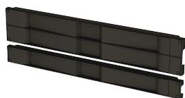
Les panneaux d'obturation sans outil (à enclenchement) permettent une installation sans outil et assurent un flux d'air adéquat vers l'équipement. Ils sont fabriqués en plastique thermique homologué UL et peuvent être utilisés avec des cornières de rack EIA à espacement universels taraudés ou carrés.
