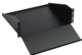
L'étagère pour clavier/moniteur en acier est conçue pour accueillir un moniteur et un clavier dans un design ergonomique. L'étagère se monte sur la bride avant d'un rack à cadre ouvert, mais peut être montée dans un coffret si les angles de rack sont ajustés en arrière pour le dégagement de la porte. Utilise un rack 3U, possède des versions de rack à 19 et 23 pouces et une charge de base prévue de 91 kg (200 lb)
