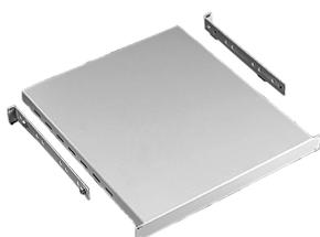
L'étagère ajustable montable sur rack se monte sur la surface avant des cornières avant et arrière du rack. Les supports d'étagère réglables sont en acier calibre 12, transparentes et réglables, pour s'adapter à des armoires à profondeurs multiples ou à des cornières de rack. Les modèles disponibles sont à la fois solides et ventilés. Ils s'adaptent à l'espacement des racks 19 ou 23 pouces et ne nécessitent qu'1U d'espace de rack. Veuillez noter que la charge de base est de 68 kg (150 lb).
