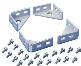
Le support de montage au sol de châssis ProLine propose une méthode structurale de boulonnage d'un châssis ProLine au sol. Le support s'adapte à toutes les tailles de châssis, le kit comprend quatre supports et le matériel de montage. Ce support ne doit pas être utilisé avec des châssis de colocation, qui incluent des supports de montage au sol soudés.
