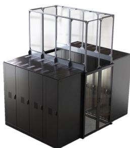
Fonctionne avec un groupe d'armoires entourant une allée chaude. Il est supporté par le haut des armoires et canalise l'air chaud évacué de l'équipement des serveurs logé dans les armoires vers un plénum de plafond. Il permet de séparer complètement l'air chaud de l'air froid, ce qui réduit considérablement les coûts énergétiques des centres de données.
