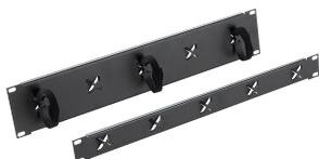
Les panneaux d'attache à cadre ouvert fournissent un point de montage pour acheminer les câbles dans un rack à cadre ouvert. Ils sont montés horizontalement sur des racks de 19 pouces et les panneaux comportent des fentes pour les serre-câbles en VELCRO®. Chaque panneau comprend 10 serre-câbles noirs en VELCRO de 8 po (203 mm) ainsi que le matériel de montage. Veuillez noter que VELCRO est une marque commerciale de Velcro Industries B.V.
