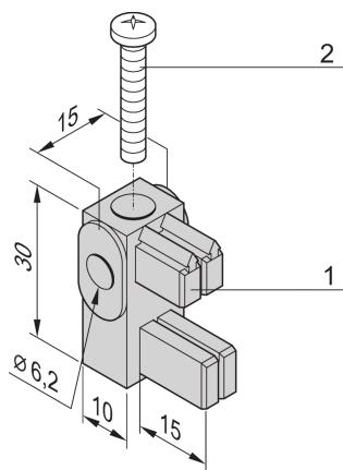
Les équerres de montage pour barres bus ou les modules de barres bus sont des unités de montage isolées du circuit de charge pour les traverses de mise à la terre. Il peut y avoir des adaptateurs avec des courants nominaux assignés qui peuvent fournir du courant de charge aux dispositifs par le biais de connexions filaires.
