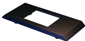
Le socle mobile pour racks à cadre ouvert offre stabilité et mobilité aux racks à cadre ouvert. Des modèles pour les racks à cadre ouvert de 19 po et à 2 et 4 montants sont disponibles. Ce produit se monte au bas des racks mentionnés précédemment. Il comprend quatre roulettes non verrouillables, mais peut aussi recevoir des niveleurs standards. Veuillez noter que la référence PMBLM12 doit être commandée séparément. Cependant, le matériel de montage est inclus.
