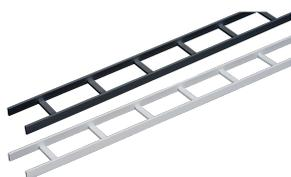
Les sections droites pour porte-échelle soutiennent les câbles sur des chemins droits. Elles sont faites d'acier tubulaire de 1-1/2 po x 3/8 po (38 mm x 8 mm) calibre 16. La longueur nominale post-installation est de 10 pieds (3,05 m). Chaque section mesure 9 pieds 11-1/2 pouces (3,03 m) de long avec des traverses soudées à des intervalles de 9 pouces (229 mm).
