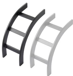
Les sections courbées en forme d'échelle permettent un changement de direction vertical. Elles sont faites d'acier tubulaire de 1 à 1/2 pouces x 3/8 pouces (38 mm x 8 mm), avec une finition peinte ou plaquée. Les traverses sont soudées à l'intérieur (courbes intérieures) ou à l'extérieur (courbes extérieures) de la section. Elles se connectent à une section droite avec des kits de raccordement. Elles sont également conçues pour les câbles catégorie 5e, 6, 6A et de fibre optique.
