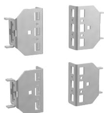
Les supports de réduction se montent directement sur des cadres ou sur des profilés ProLine de 700 ou 800 mm de largeur. Ils convertissent des cadres plus larges en 600 mm de largeur, permettant le montage de cornières de rack de 19 po, ou en 700 mm de largeur, pour des cornières de rack de 23 po. Ils peuvent être utilisés pour aligner à gauche ou à droite des équipements montés sur rack. Veuillez noter qu'ils sont fournis par lots de quatre et que le matériel de montage est inclus.
