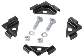
Le kit de raccordement de chemin de câbles raccorde deux sections droites de chemins de câbles à un angle de 90 degrés sur un même niveau. Chaque kit raccorde une section à une autre. Le kit comprend des supports et du matériel de montage pour raccorder les extrémités des sections de chemin de câbles. .
