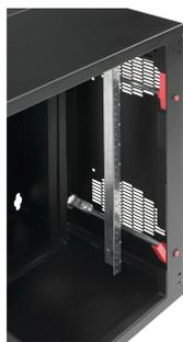
Les cornières AccessPlus sont utilisées pour monter un équipement de rack 19 po à l'intérieur d'un boîtier AccessPlus. Elles ont des trous de montage en rack EIA universels espacés de 19 po marqués RU de bas en haut. Les trous des cornières sont soit taraudés (10-32), soit carrés. Veuillez noter que vingt vis de montage sont incluses.
