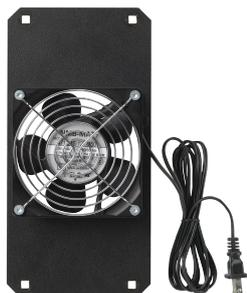
Les kits de ventilateur AccessPlus de quatre pouces à 115V.c.a, sont une solution pour la ventilation des armoires à 100CFM. La plaque de montage et le matériel sont inclus. La petite plaque de montage mesure 5,32 po (135 mm) x 8,00 po (203 mm) et convient aux armoires ou C = 18,00. La grande plaque de montage mesure 5,32 po (135 mm) x 10,75 po (273 mm) et convient aux boîtiers ou C = 25,00 ou 30,00.
