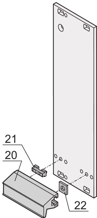
La poignée profilé aluminium statique, de forme trapézoïdale peut être montée sur une face avant pour l'extraction du circuit imprimé.
