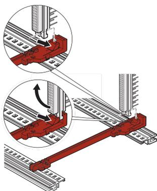
Le guide-carte de type standard pour connecteurs permet à l'utilisateur de clipser les connecteurs DIN (EN 60603-2 (DIN 41612)) directement sur les guide-cartes. Applicable uniquement aux cartes euro de dimensions 100 x 160 mm et 100 x 220 mm. Compatible avec RatiopacPRO Air, PropacPRO, CompacPRO et EuropacPRO.
