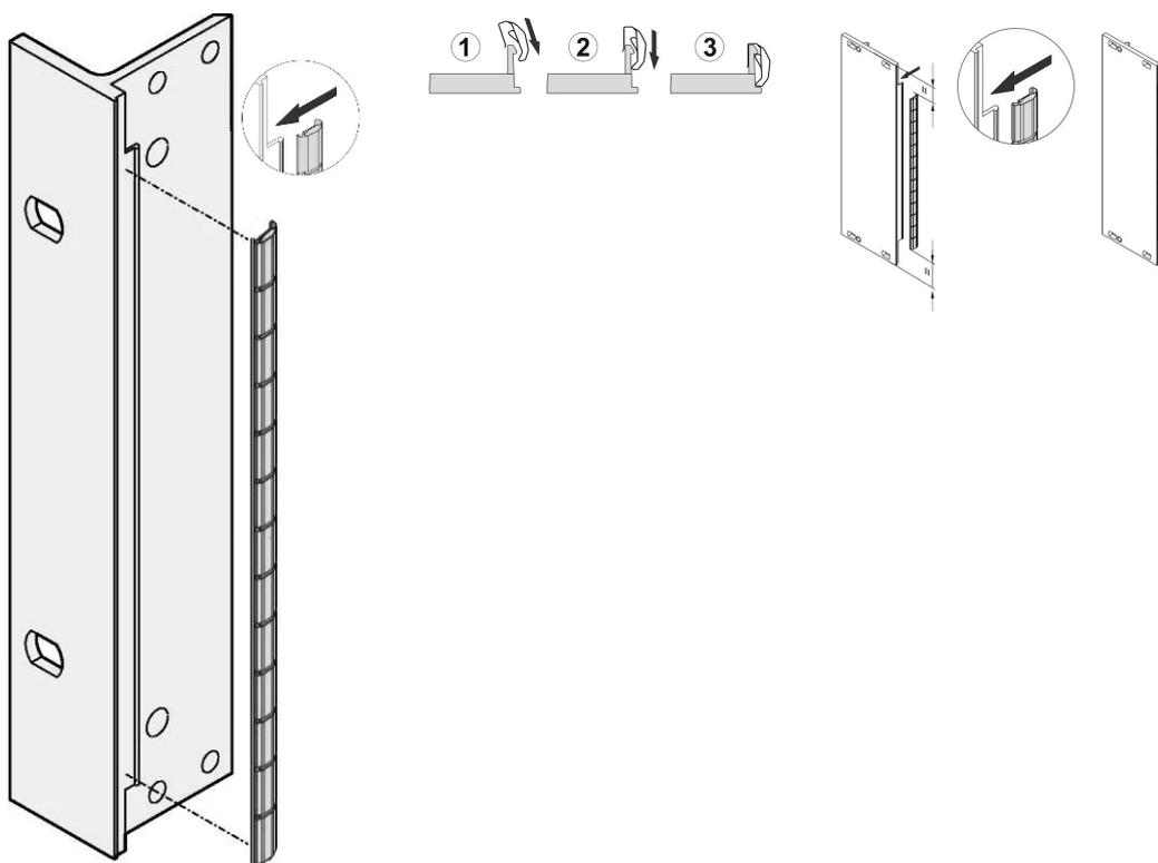
Les joints CEM en acier inoxydable sont insérés dans un emplacement sur le côté droit des faces avant en forme de U.
