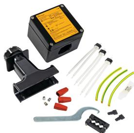
Le modèle nVent RAYCHEM T-100 est un kit de jonction ou de dérivation en T à profil élevé installable à froid pour les câbles chauffants de traçage électrique dans les zones explosibles et non explosibles. Monté sur le conduit, à travers le calorifugeage et le plâchage. Comprend un embout d'étanchéité pour câble chauffant installé à froid.
