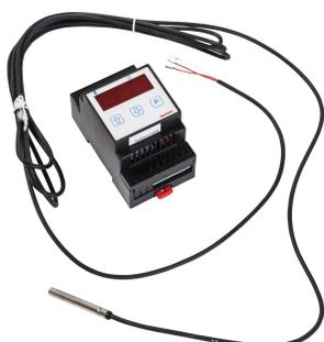
Le nVent RAYCHEM RAYSTAT-CONTROL-11-DIN est un régulateur électronique de température à détection de ligne avec relais avertisseur, pour les câbles chauffants autorégulés dans les applications de mise hors gel de tuyauteries ou de maintien en température.
