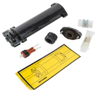
Le modèle nVent RAYCHEM C-150-E est un connecteur à isolant thermique, faible encombrement, sous calorifuge, installé à froid sur le câble d'alimentation électrique flexible, à utiliser avec le modèle nVent RAYCHEM BTV, QTVR, XTV et KTV. Il peut être utilisé dans des applications dont la température nominale est comprise entre  $-50\text{ }^{\circ}\text{C}$  et  $215\text{ }^{\circ}\text{C}$ .
