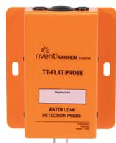
La sonde nVent RAYCHEM TraceTek TT-FLAT-PROBE est utilisée pour détecter les fuites d'eau aux endroits bas, dans les bacs collecteurs ou les bassins. Elle est conçue pour être intégrée dans un système de détection de fuites de plus grande envergure, surveillé par un régulateur nVent RAYCHEM TraceTek, comme par exemple un module TTDM-128 ou TT-SIM.
