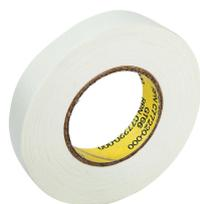
Le modèle nVent RAYCHEM GT-66 est un ruban en fibre de verre d'installation pour fixer les câbles chauffants de traçage électrique aux conduits. Pour l'acier inoxydable ou lorsque les températures d'installation sont inférieures à 40 °F / 5 C°, utilisez le ruban de fixation GS-54. Le ruban en aluminium AT-180 / ATE-180 permet de fixer des câbles chauffants et des sondes de thermostat sur les tuyauteries et réservoirs.
