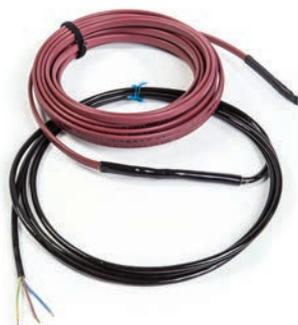
Les kits XL-Trace LSZH comprennent le ruban chauffant autorégulant 10XL2-ZH doté d'un câble de sortie froide de 4 m sans halogène, à faible dégagement de fumée (LSOH) préinstallé, d'une jonction entre la sortie froide et le câble du ruban chauffant, et d'une terminaison – le tout terminé en usine et soumis à des essais électriques. Les kits sont disponibles dans des longueurs fixes comprises entre 3 et 30 m.
