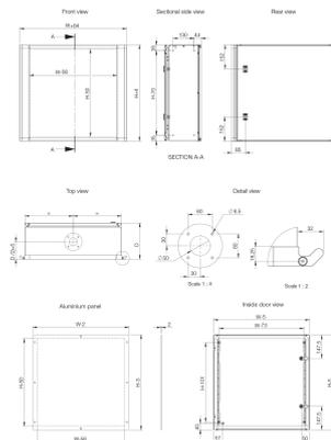
L'armoire de commande d'interface opérateur en acier doux, OICE, présente un modèle de perforations préusinées pour permettre la fixation à un bras pivotant, et une plaque avant amovible à un indice de protection IP 55. Les composants peuvent être facilement montés grâce à la plaque avant amovible, et sont également accessibles par une porte arrière. Les poignées latérales sur l'armoire permettent un déplacement aisé de l'armoire vers la position de travail.
