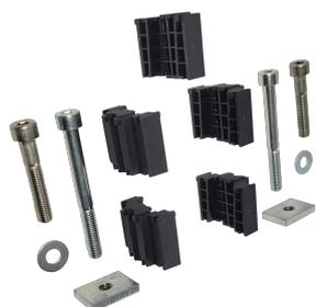
Kit de court-circuit élevé conçu pour la mise à niveau du nVent ERIFLEX IFBS afin qu'il puisse résister à des valeurs de court-circuit élevées jusqu'à 130 kA en crête. Ce kit comprend deux écrous de rail de montage, deux vis à tête M8 – CHC (75 mm), deux vis à tête M8 – CHC (40 mm) et cinq entretoises renforcées.
