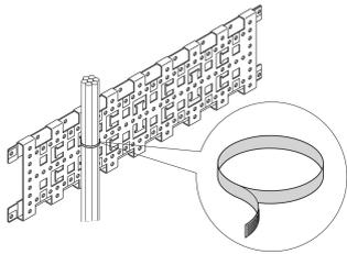
La bande Velcro® est l'une des solutions de faisceaux de câbles les plus simples. La bande Velcro® nVent SCHROFF accepte un diamètre de câble allant jusqu'à 43 mm.
