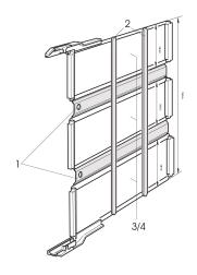
Kit de soporte para hacer un adaptador de 6 / 9 U Testadapter a partir de 3 U Testadapters. Adecuado para adaptadores de prueba con conectores DIN 41612 Tipo B, C, E y F..
