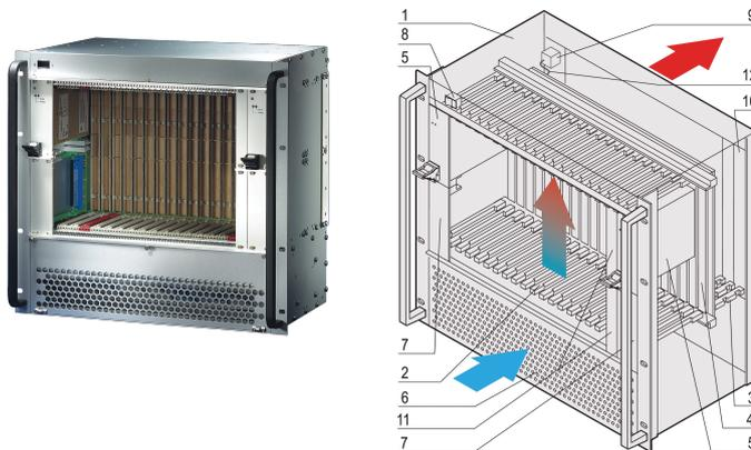
Sistema CompactPCI de 10 U con PSB para catorce placas de 6 U, catorce placas RTM y hasta cuatro fuentes de alimentación conectables de 3U.
