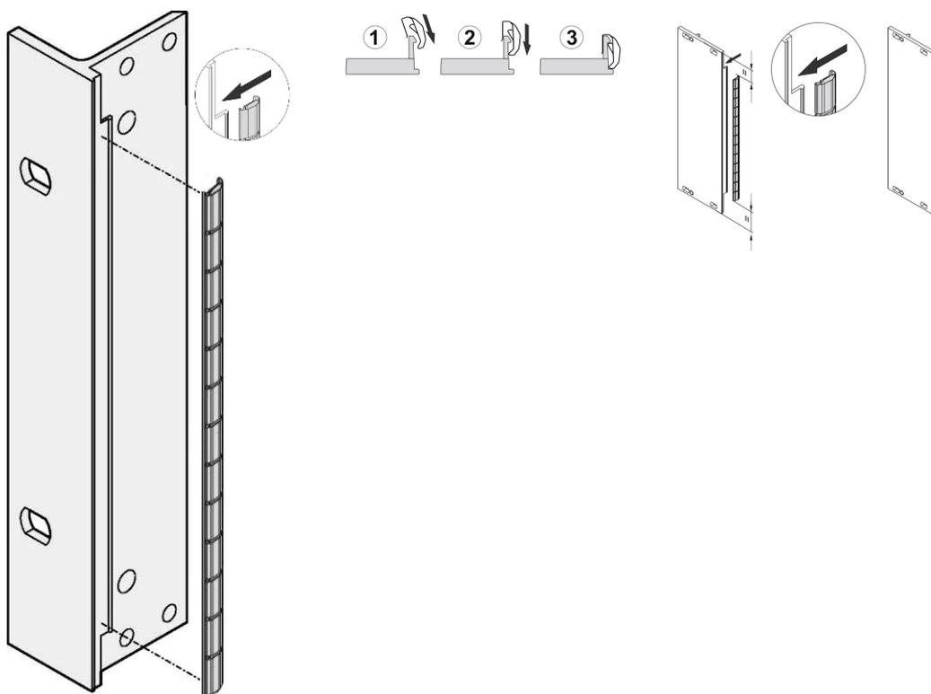
Las juntas EMC de acero inoxidable se insertan en una ranura en el lado derecho de los paneles frontales en forma de U.
