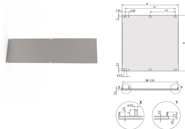
Panel frontal de perfil en U para junta textil EMC.
