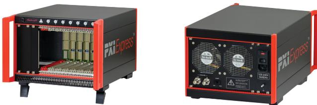
El sistema de 8 ranuras nVent SCHROFF PXIe tiene una ranura de sistema de 16HP con configuración de 4 enlaces. 3 de las ranuras periféricas híbridas están conectadas por enlaces PCIe Gen 3 con carriles x4. Las 4 ranuras periféricas híbridas restantes están conectadas con enlaces PCIe Gen 2 con 1 carril cada una.
