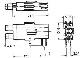
Dobles tomas de prueba para el montaje de los planos 1 y 2, tipo corto y largo.
