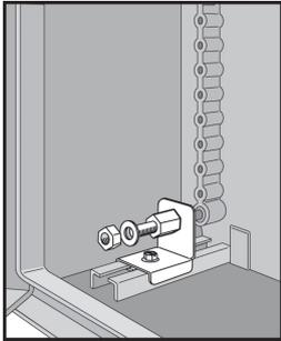
El kit de soporte de panel Ultrx se utiliza con paneles y permite el ajuste del panel de adelante hacia atrás. Se ajusta a todos los tamaños de gabinete Ultrx. Se monta en un riel de cuerpo moldeado integralmente. Se incluyen los herrajes de montaje.
