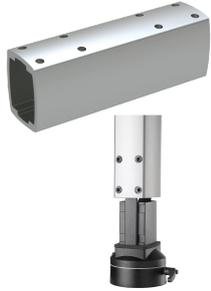
Los tubos Syspend 281-Max brindan integridad estructural y actúan como tubo para el cableado del equipo. Los tubos se conectan a los componentes del sistema con 6 tornillos de fijación en cada extremo del tubo. Los tornillos de fijación permiten un fácil ajuste y nivelación del sistema. Los tornillos de fijación se proporcionan con sellador de roscas que proporciona conexiones seguras.
