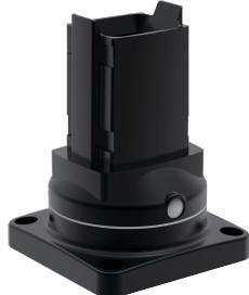
La base giratoria Sysspend 281-Max permite que todo el sistema de suspensión gire en el punto de unión en una superficie horizontal. El brazo tiene una capacidad de rotación o giro de 300 grados. Incluye tope de seguridad y rodamiento libre de mantenimiento.
