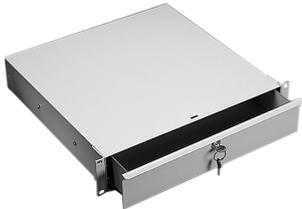
El cajón montado en ángulo para rack es para montaje en ángulo para rack de 19 pulg. en la superficie frontal de los ángulos para rack. La caja integral contiene el cajón y protege el equipo interno circundante. Se extiende 13 pulg (330 mm) sobre guías con rodamientos de bolas. El frente incluye manija y sistema de cierre. Se incluyen herrajes de montaje.
