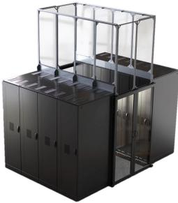
Funciona con un grupo de gabinetes que rodean un pasillo caliente. Está soportado en la parte superior de los gabinetes y canaliza el aire caliente que escapa del equipo de servidores alojados dentro de los gabinetes hacia el plenum en el techo. Esto se usa para separar completamente el aire frío del aire caliente, lo que reduce drásticamente los costos de energía del centro de datos.
