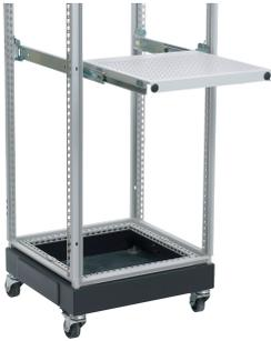
El estante extraíble del marco permite un acceso fácil a los dispositivos montados en el estante. El estante cuenta con soportes de acero calibre 12. El estante se monta en las verticales delanteras y traseras del marco. Clasificación de carga de 110 lb (50 kg).
