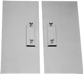
Los estabilizadores de gabinete ayudan a evitar lesiones a los trabajadores al estabilizar los gabinetes de montaje en piso que no están atornillados. Para la instalación, deslice el estabilizador debajo de la base de piso y apriete dos tornillos de ajuste manual.
