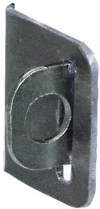
El kit de candado D-Box permite que los gabinetes se cierren con candado, lo que proporciona seguridad adicional para proteger a los equipos del interior. Incluye una cerrojo y grapa instalables en campo. Se adapta a candados con un diámetro máximo de grillete de 5/16 pulg. (8 mm) y no requiere taladrado ni trazado. Tenga en cuenta que el kit incluye hardware de montaje.
