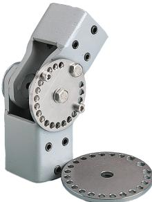
El limitador de rotación Compact Series 4 es un accesorio para usar con junta de pared, junta de pared de cable y unión intermedia. Limita la rotación de estas articulaciones que normalmente giran 180° y proporciona paradas en incrementos de 15°.
