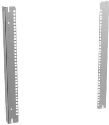
Los ángulos de rack de montaje en pared ComLine OSP se utilizan para montar equipos de rack de 19 pulgadas dentro del gabinete. Se conectan a tierra al cuerpo del gabinete mediante los pernos de montaje. Tenga en cuenta que los orificios de montaje cuadrados cumplen con el estándar EIA y cada paquete incluye un par.
