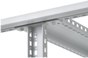
Los verticales centrales son canales verticales que se unen al marco (superior e inferior). Puede usarse en marcos de 800, 1000, 1200 y 1600 mm de ancho para facilitar la instalación de accesorios para marcos de 600 mm de ancho y 19 pulgadas. Accesorios para rack en marcos más anchos. El patrón de orificio vertical concuerda con el patrón de orificio vertical del marco. Los montantes verticales centrales se suministran en pares e incluyen accesorios de montaje.
