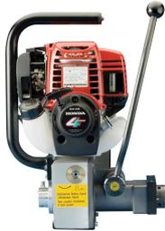
La gama SBM-V de brocas para raíles están diseñadas para brindar una operación suave, de confianza y poderosa. Trabaja con productos de todos los tamaños, desde aplicaciones para señalización de orificios de adhesión hasta tamaños de orificios de eclisas. Se ofrece una amplia gama de accesorios, incluyendo unidades de sujeción, cortadoras de brocas y plantillas para aplicaciones especiales.
